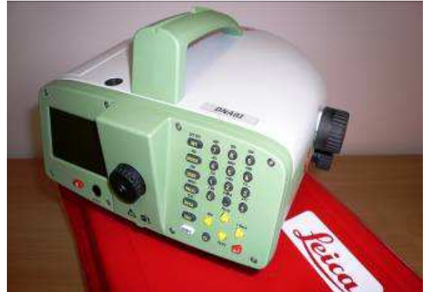
Leica DNA03 – Präzisions-Digitalnivellier
